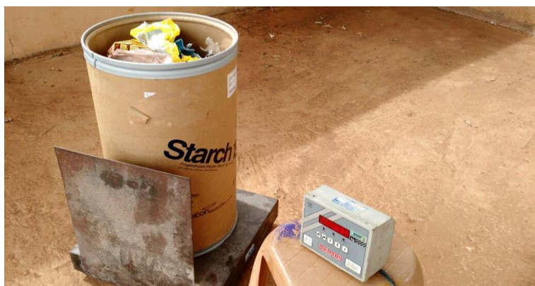
Figura 4 – Acondicionamento e pesagem dos resíduos
