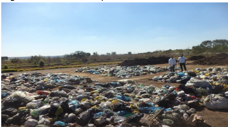
Figura 3 – Técnica do quarteamento
