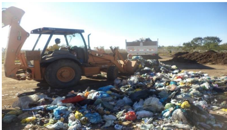
Figura 2- Uso de retroscavadeira para homogeneização dos resíduos
